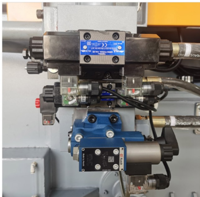
先导式溢流控制液压系统 Pilot overflow control hydraulic system
