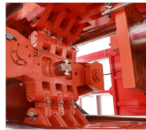
高强度的机铰设计 High strength toggle design
